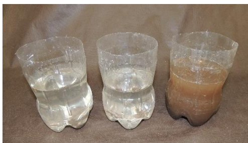
Figura 26. Resultado da perda de solo no experimento montado para demonstrar o efeito da cobertura viva (esquerda), morta (centro) e sem cobertura (direita). Foto: Marcelo Ricardo de Lima.
