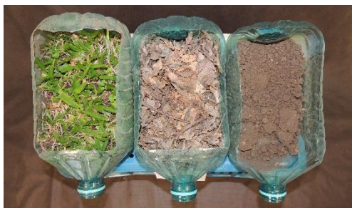
Figura 25. Experimento montado para demonstrar o efeito da cobertura viva (esquerda), morta (centro) e sem cobertura (direita) na erosão do solo. Foto: Marcelo Ricardo de Lima.
