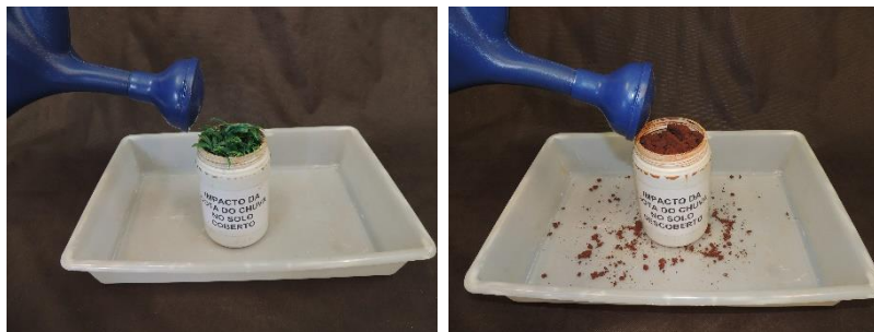
Figura 24. Experimento que mostra o efeito do impacto da gota da chuva no solo coberto (esquerda) e descoberto (direita). Observe na direita a quantidade de solo que foi “espirrada” devido o impacto da gota d’água. Fotos: Marcelo Ricardo de Lima.
