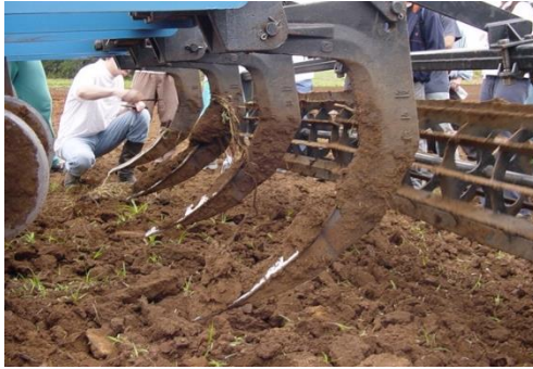
Figura 9. Equipamento (escarificador) utilizado para romper camadas compactadas do solo, no município de Pinhais (PR). Foto: arquivo do Programa Solo na Escola/UFPR.
