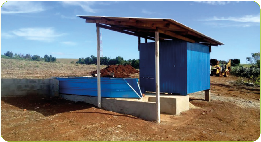
Figura 3 – Calha H instalada em uma megaparcela na bacia hidrográfica de Dois Vizinhos-PR
