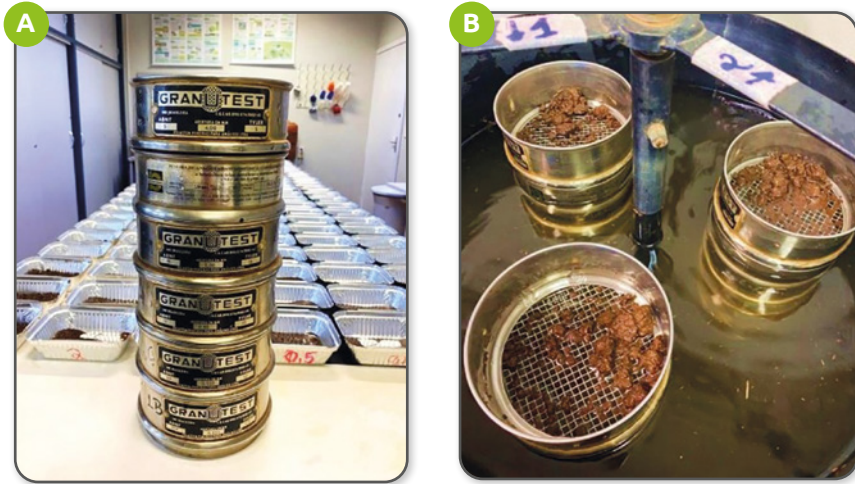
Figura 8 – Instrumentais utilizados no peneiramento úmido de agregados para determinação da estabilidade de agregados do solo
