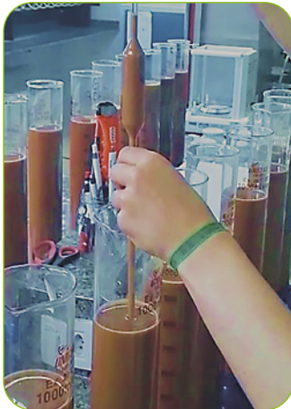
Figura 5 – Suspensão aquosa acondicionada em provetas de 1.000 mL aguardando o tempo de sedimentação das frações silte e argila – Guarapuava-PR Fonte: Cristiano Andre Pott (2021).
