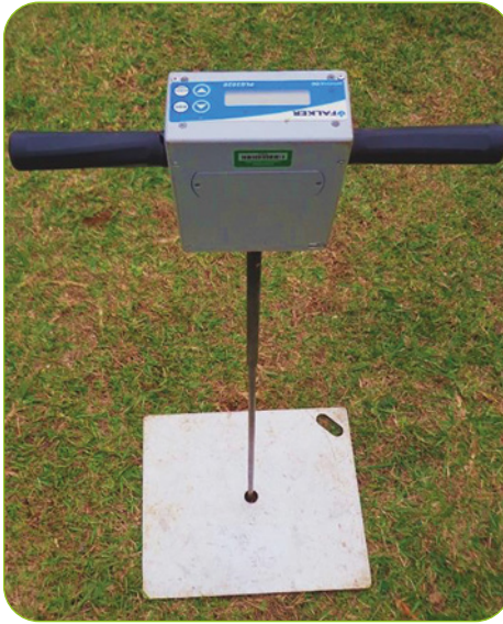
Figura 14 – Penetrômetro eletrônico utilizado para medir a resistência do solo à penetração
