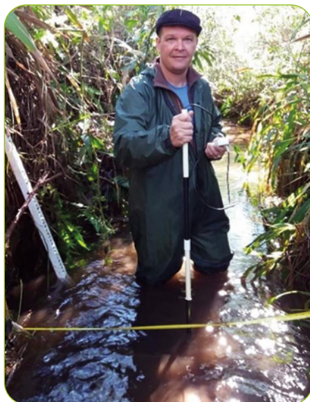
Figura 4 – Medição da velocidade do escoamento do rio, com uso de molinete hidrológico, no rio da bacia hidrográfica de Guarapuava-PR
