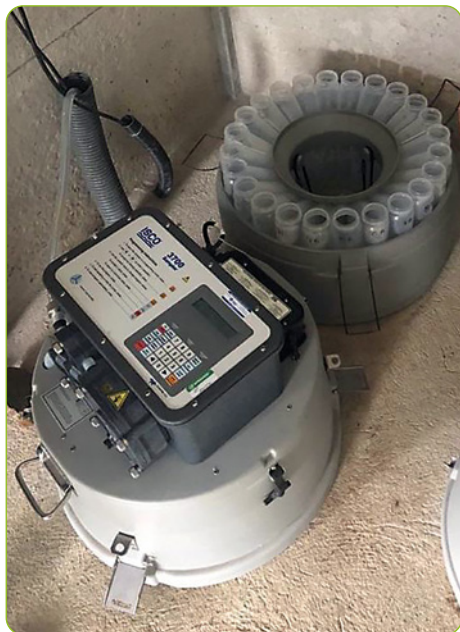
Figura 17 – Amostrador automático de água para coletar amostras de água e sedimentos em suspensão
