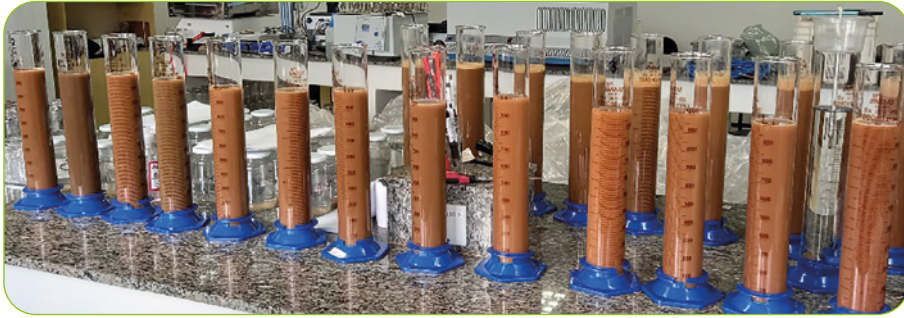
Figura 5 – Suspensão aquosa acondicionada em provetas de 1.000 mL aguardando o tempo de sedimentação das frações silte e argila – Guarapuava-PR Fonte: Cristiano Andre Pott (2021).
