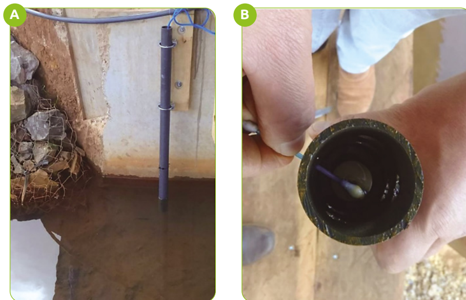
Figura 14 – Sensor de turbidez e limpeza da lente do sensor de turbidez, na seção de monitoramento da bacia hidrográfica de Guarapuava-PR
