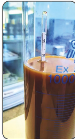
Figura 5 – Suspensão aquosa acondicionada em provetas de 1.000 mL aguardando o tempo de sedimentação das frações silte e argila – Guarapuava-PR Fonte: Cristiano Andre Pott (2021).
