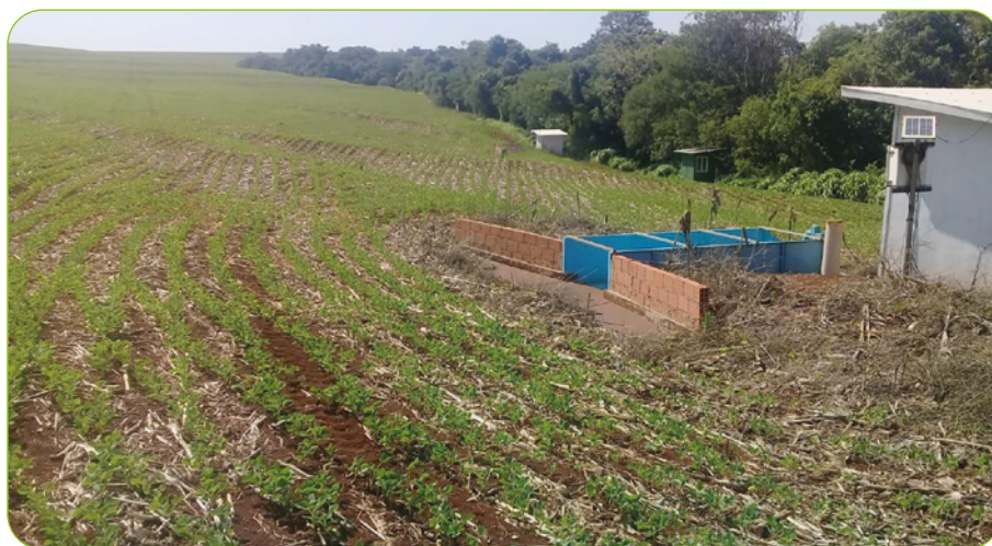
Figura 5 – Calha H instalada em uma megaparcela na bacia hidrográfica de Toledo-PR
