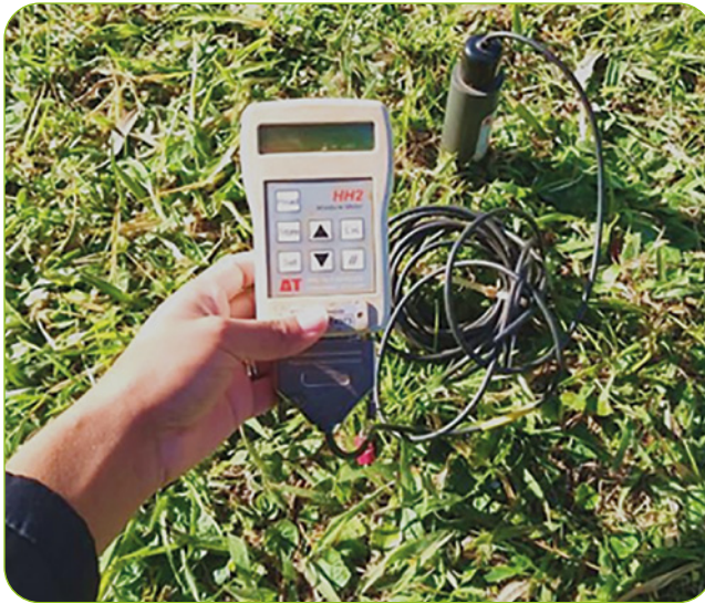
Figura 15 – Sensor utilizado na determinação do conteúdo volumétrico de água no momento das leituras da resistência do solo à penetração – Ponta Grossa-PR Fonte: Neyde Fabíola Balarezo Giarola (2021).
