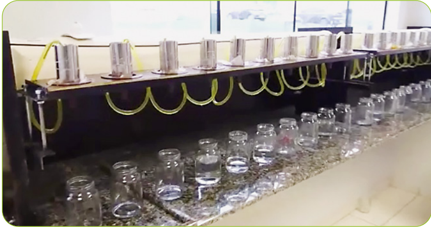
Figura 12 – Permeômetro de carga constante utilizado na determinação da condutividade hidráulica saturada em amostras de solo com estrutura preservada – Guaruapuava-PR
