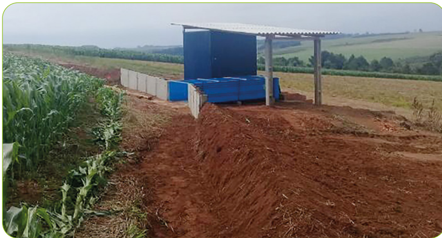
Figura 1 – Calha H instalada em uma megaparcela na bacia hidrográfica de Ponta Grossa-PR
