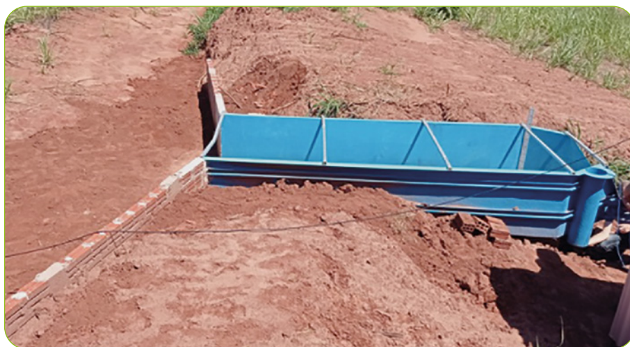
Figura 7 – Calha H instalada em uma megaparcela na bacia hidrográfica de Presidente Castelo Branco-PR
