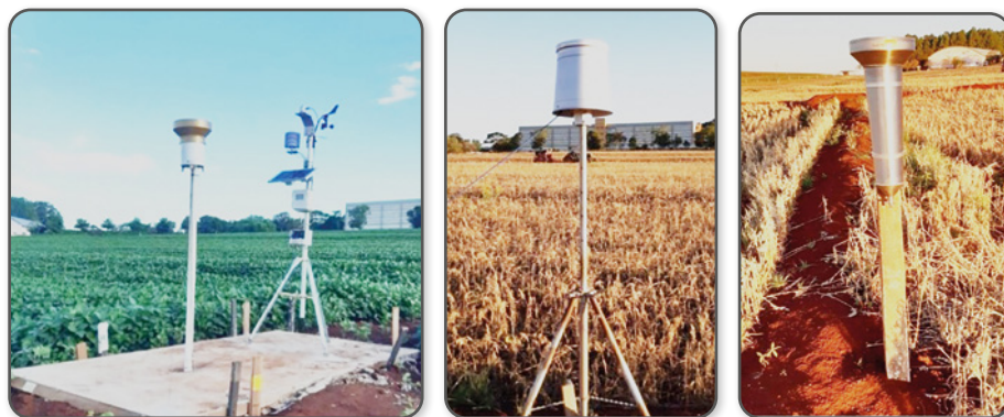
Figura 23 – Estação meteorológica, pluviógrafo e pluviômetro utilizados para o monitoramento da precipitação e demais dados meteorológicos da bacia hidrográfica de Dois Vizinhos-PR
