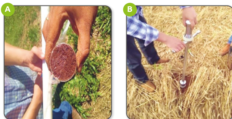
Figura 2 – Coleta de amostras de solo com estrutura preservada – Ponta Grossa-PR Fonte: Eduardo Augusto Agnellos Barbosa (2020).
