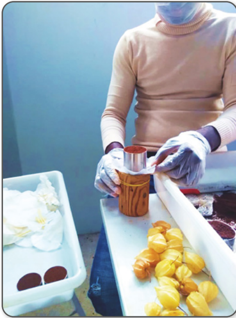
Figura 3 – Colocação do tecido de proteção na parte inferior do cilindro metálico, durante a fase de preparação das amostras com estrutura preservada
