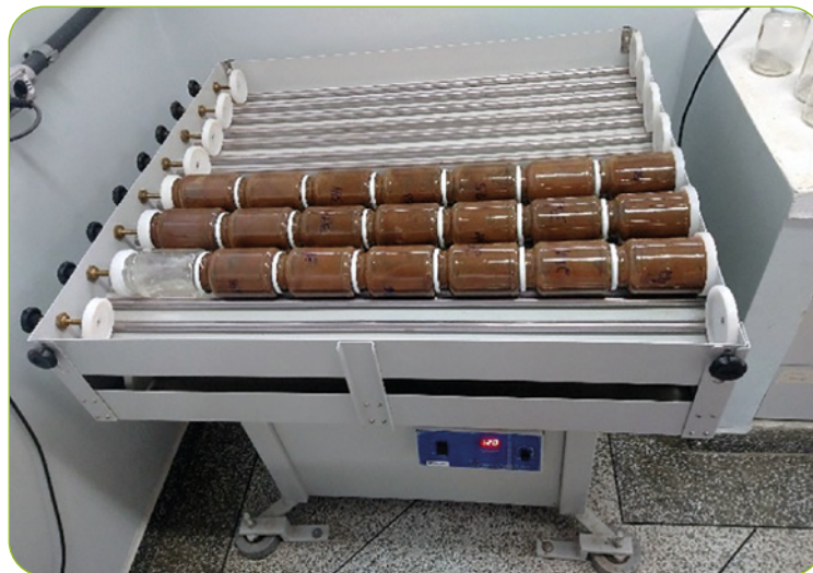
Figura 4 – Mesa agitadora com movimento recíprocante utilizada na etapa de dispersão da terra fina seca ao ar, durante a análise granulométrica do solo – Ponta Grossa-PR Fonte: Ariane Lentice de Paula (2022).
