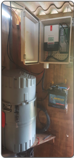
Figura 26 – Amostrador automático de sedimentos instalado próximo à calha H na bacia hidrográfica de Cambé-PR
