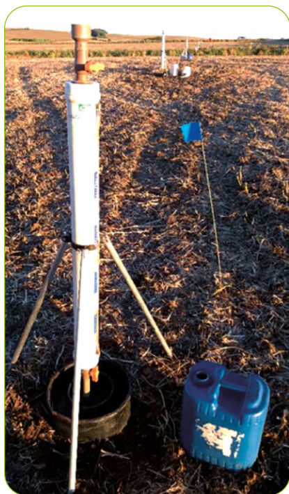
Figura 13 – Infiltrômetro de duplo anel com carga constante em funcionamento nas megaparcelas de Guarapuava-PR Fonte: Cristiano Andre Pott (2019).
