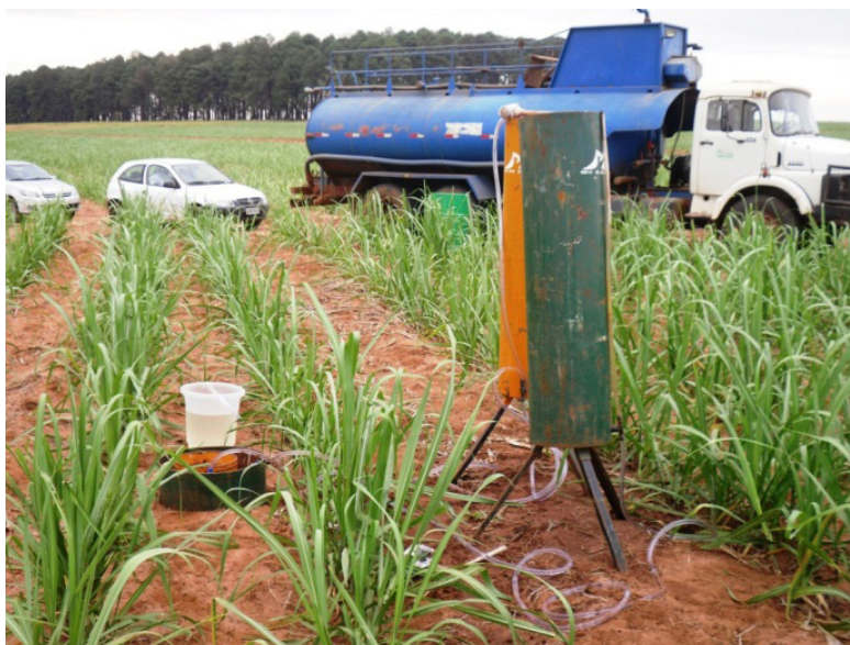
Figura 2. Infiltrômetro de anel utilizado para medir a taxa de infiltração de água no solo.
