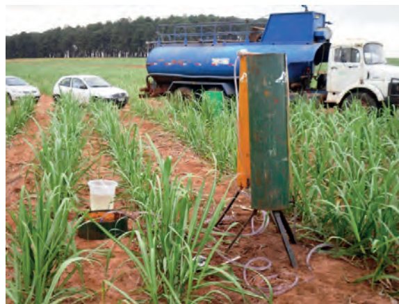
Figura 2. Infiltrômetro de anel utilizado para medir a taxa de infiltração de água no solo.
